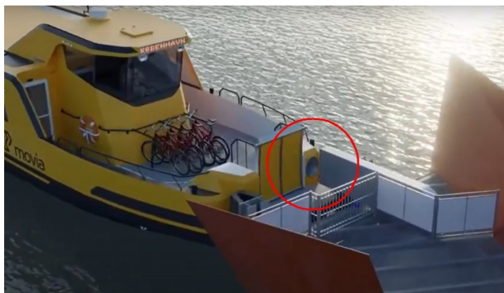
Figur 9: Köpenhamnfärja med ladd-utrustning vid en terminal, bild Damen.com
