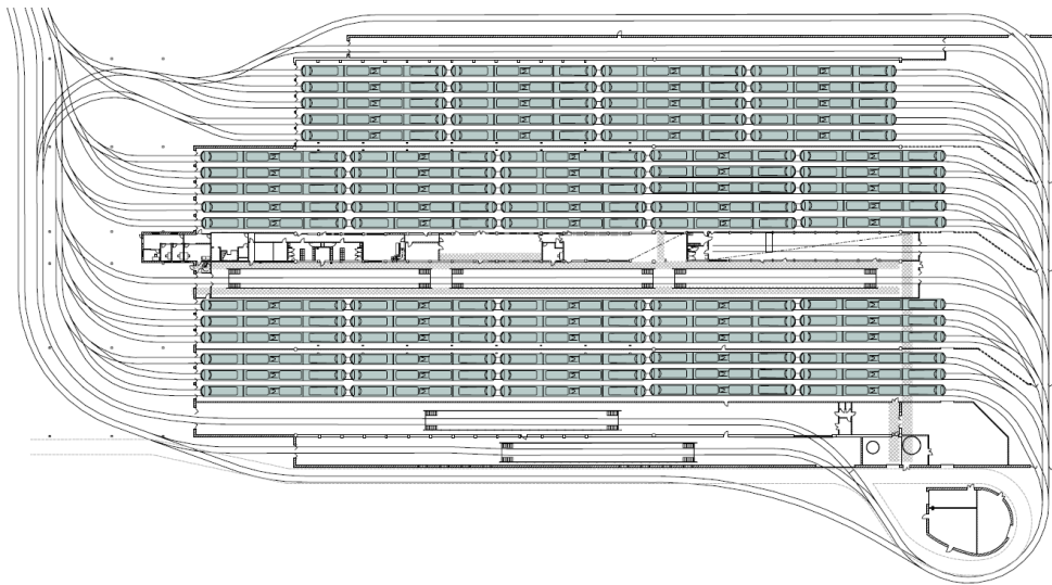
Figur 10: Uppställning situation 1; 75 styck vagnar (M33).
